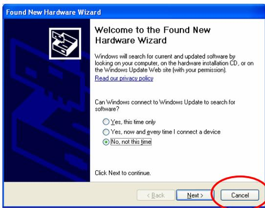
DiViS CAP, ACAP, LIVCAP, AMX, D1 y H.264 pueden ser instalados con "installer.exe", cual determina el modelo de DVR y instala el correspondiente driver. Si instala la tarjeta por primera vez, este mensaje aparecerá. Haga clic en "Cancel".
