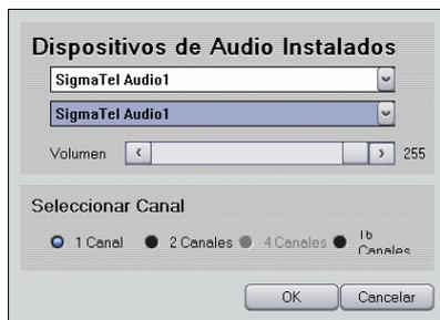
**Dispositivos de Audio Instalados**: Si hay un dispositivo, grabación de hasta 2 canales de audio están disponibles. Si hay 2 dispositivos disponibles 4 canales podrán ser utilizados. Para 16 canales, una tarjeta especial será necesaria.
